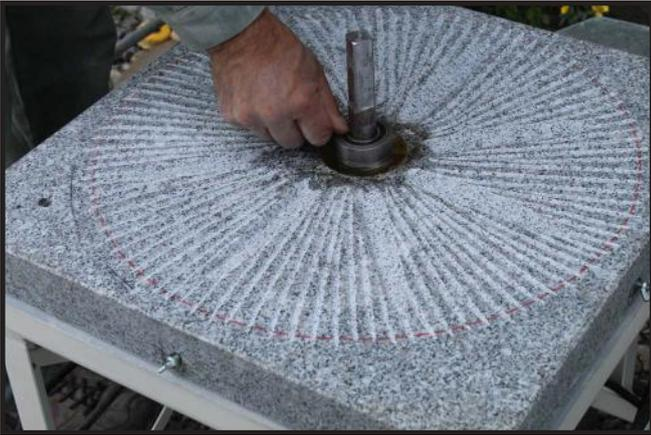
Pose du roulement de la meule volante
